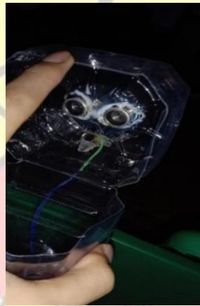
Gambar 6. Sensor Ultrasonik Pada Tandon Pelet
