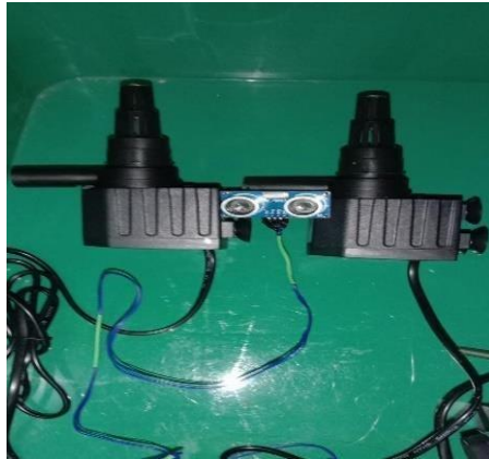
Gambar 7. Sensor Ultrasonik Untuk Ketinggian air dan Pompa air
