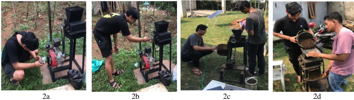
Gambar 2. a. Pengukuran Rpm mesin tanpa perlakuan, b. Pengukuran rpm pisau, c,d. Pengujian kinerja Mesin
