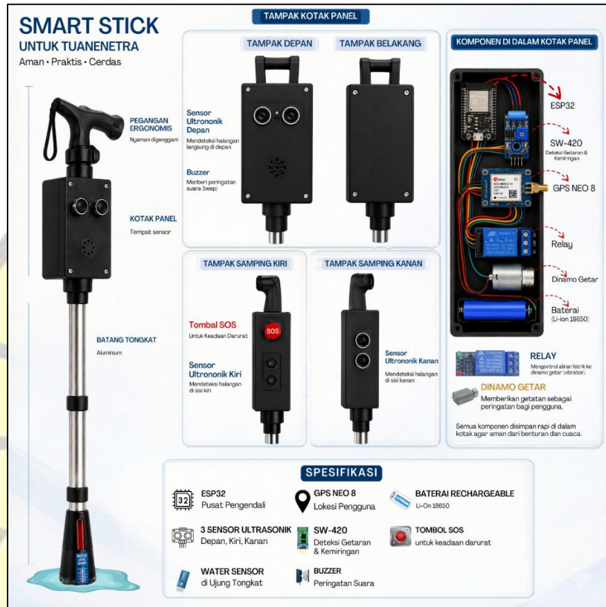
Gambar 1. Prototipe Smart Stick dan penempatan komponen sensor
